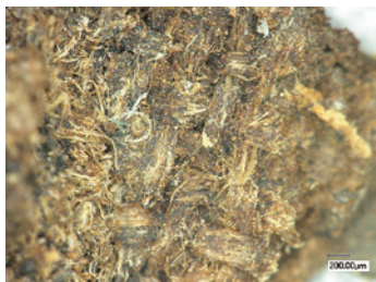
図26 塗膜片 裏 部分拡大④ 布貼りが見える
