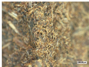
図24 塗膜片 裏 刻芋彫り部分 拡大② 繊維が見える
